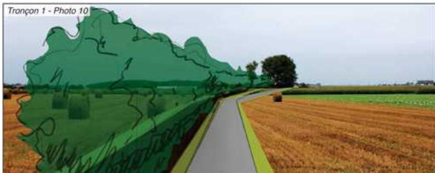
Dans cet espace, la piste est bordée de part et d'autre de bandes enherbées. Côté droit, la bande enherbée est de 0,5 m de large. Elle est également de 0,5 m côté gauche, et une haie champêtre est implantée en limite de cette bande .
